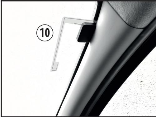
Installare l'antenna DAB+ sulla parte destra del parabrezza con la parte color bronzo a contatto con la carrozzeria del veicolo (fondamentale per l'alimentazione dell'antenna).
